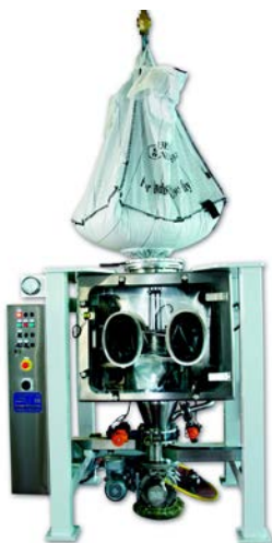
Big-Bag-Entleerung mit Endlos-Foliensystem in Glove-Box
