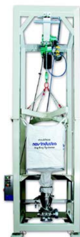
Big-Bag-Entleerung auf Wägezellen mit Andocksystem und Zellenradschleuse
