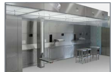
LAF Umluftkabine mit Einwaage und Probenzug
